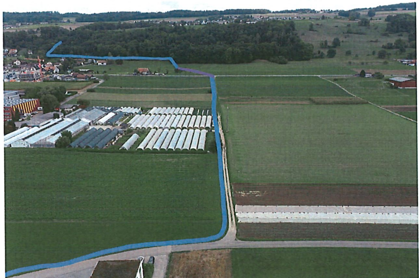
Gesamtübersicht mit projektiertem Bachlauf offen (hellblau) und eingedolt (violett)
